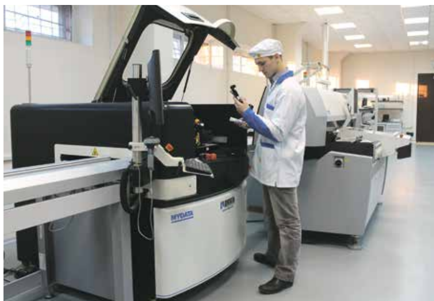
Работа студентов на автоматизированной линии подготовки и пайки электро-радиоэлементов на печатных платах
