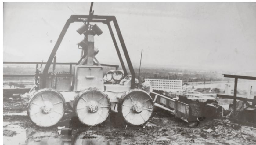
Робот по очистке крыши реактора
